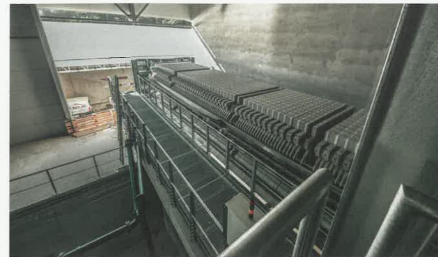
Bild 2: Filterpresse von MSE mit Filterplatten Lenser i-Plate zur Schlammwässerung in der Regen- und Prozesswasseraufbereitungsanlage
